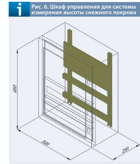
**Рис. 6. Шкаф управления для системы измерения высоты снежного покрова**
