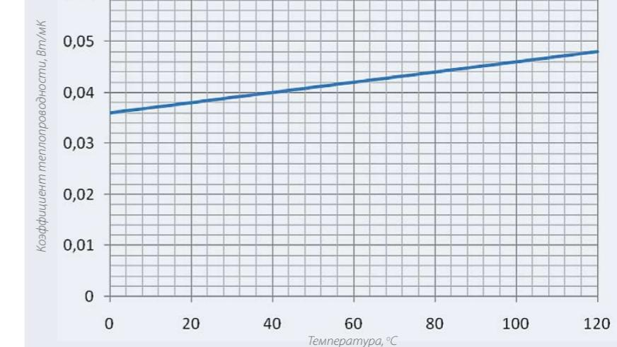
Рис. 1. Температурная зависимость коэффициента теплопроводности InWarm Flex.  $\lambda_1 = \lambda_{20} + 0,0001(T - 20)$
