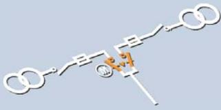
Автоматическое переключение между основным вводом от трансформатора и резервным вводом от дизель-генераторной установки (ДГУ)
