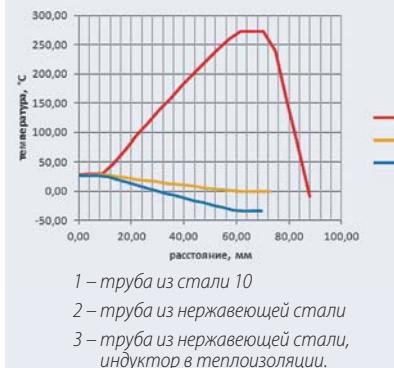
тор укрыт тепловой изоляцией. Тепловыделение в нержавеющей трубе 5000 Вт/м. ТИ<sub>1</sub>=50 мм; ТИ<sub>2</sub> = 15 мм. Температура индуктора: 273 °C, Температура стенки трубы: 27 °C.
