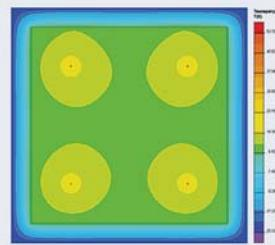
Время разогрева  $t = 27,0$  часов.Средняя температура по объему бетонной массы  $T_v = 10,3$  °C.Минимальная температура на поверхности сваи  $T_{min} = 8,1$  °C.
