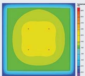
Время разогрева  $t = 19,6$  часа.Средняя температура по объему бетонной массы  $T_v = 14,4$  °C.Минимальная температура на поверхности сваи  $T_{min} = 8,1$  °C.
