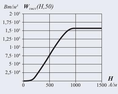
ности нагрева. Укажем, что при использовании сильных электромагнитных полей потерями на гистерезис в ферромагнитной стали можно пренебречь.
