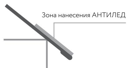
отверждения композиции не должно быть осадков. Композицию наносят не менее, чем в 2 слоя методами безвоздушного, пневматического распыления, кистью или валиком. Температура окрашиваемой поверхности должна на  $3^\circ$  превышать температуру точки росы. Температура эксплуатации от -60 до +150 °C
